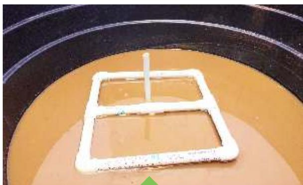
**Imágenes.** Dispositivo flotante de cabeza constante en el tanque de almacenamiento de aguas pretratadas.
