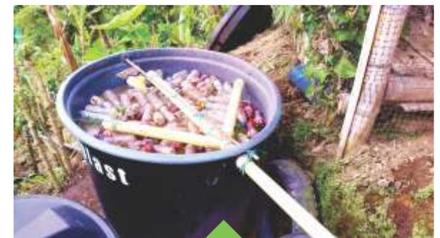
**Imágenes.** Aguas del primer y segundo enjuague para recircular en el procesador de pulpas, y aguas del tercer y cuarto enjuague para un sistema de reactor hidrolítico.
